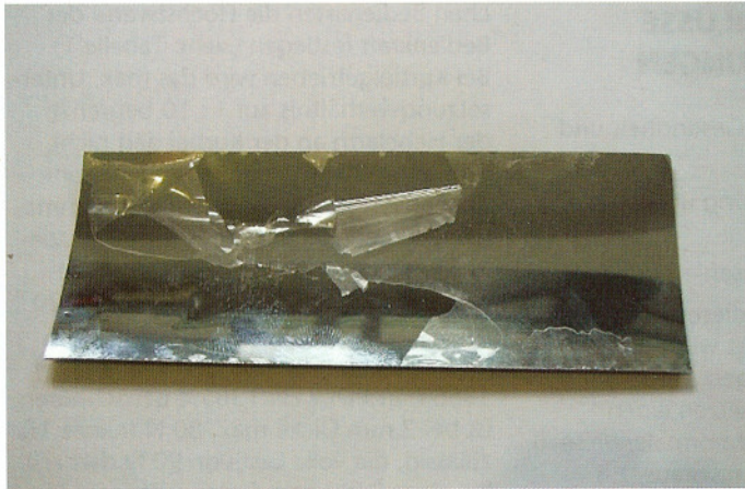
Ablösung der Beschichtung bei einer TLT-Jalousie
