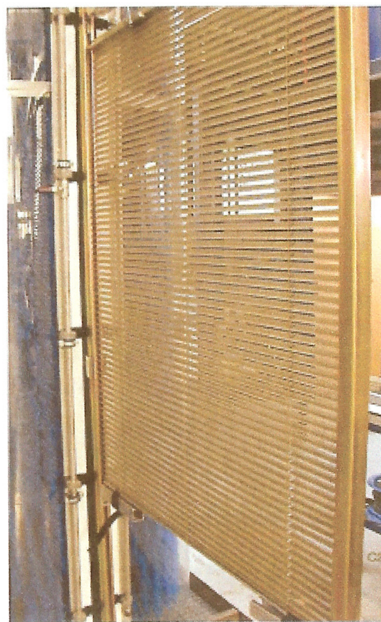
Innen- und Außenjalousien werden in einem Bürst-Walzverfahren, ähnlich der Waschstraße bei Autos, behandelt (Foto: VDS e.V.)
